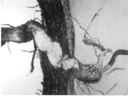
4.5 Perforación producida por raíces de cardos en una membrana asfáltica de cerca de 15mm de espesor, después de 15 meses de duración del ensayo (Pennigsfeld et al. 1981)
