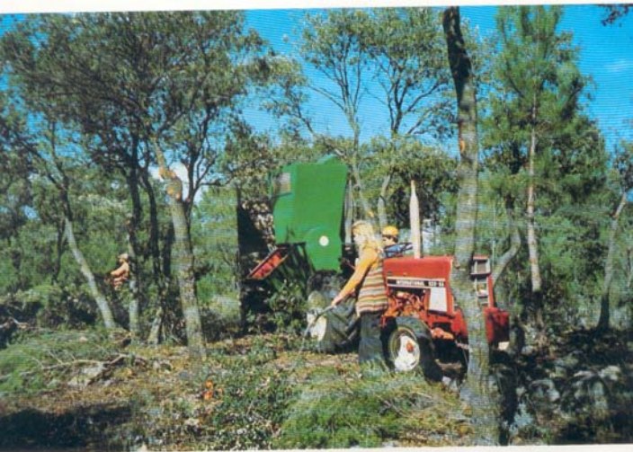
Opération de débroussaillage et de broyage-affinage en action.
